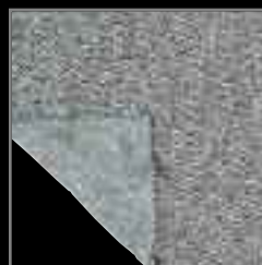
XLT-LITE CHAMBRAY MC 100% Aramide aiguillé 7.8 onces/vg 2 Piqué à un tissu 100% Nomex® calendré et teint en solution, couleur gris, tissage « Rip Stop »
